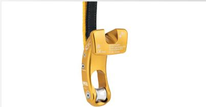
フォールスクロッチ『イジェクト』および『ナジャ』は、シールドボールベアリング内蔵のプーリー付きです。支点でのロープの流れがスムーズになるため、効率の良いロープ登高および樹冠内の移動が可能です。
